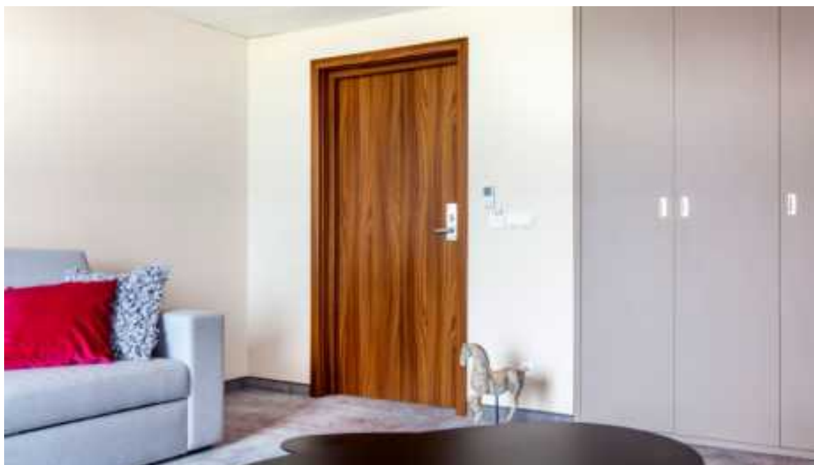
drzwi EI60 PLUS, ościeżnica regulowana drewniana
