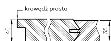
Przekrój poziomy drzwi Elsa
