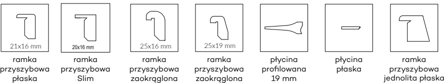
Przekrój poziomy drzwi przylgowych VETRO E
